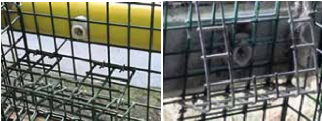
Ruokalappuja on pyritty vähentämään laskemalla juottonippo- ja/tai virittämällä verkkonpala nipan alle tai ympärille. Kuvat Kent Nygård.
