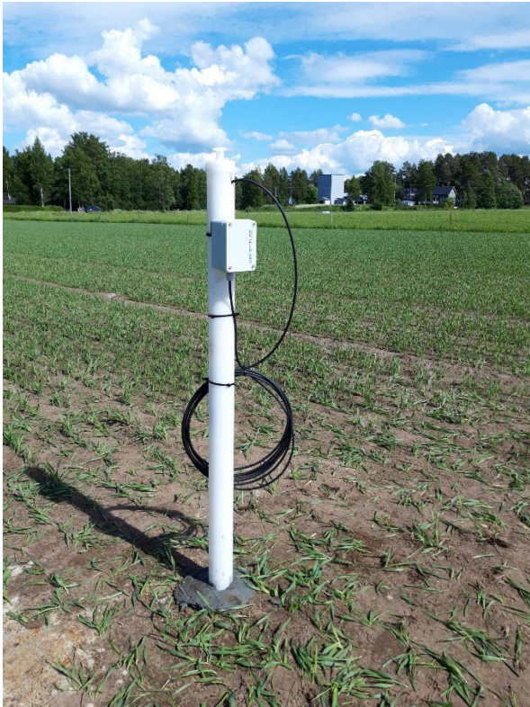
Kuva 10. Kannuksen toimipaikan pellolle perustettiin 9 pohjaveden mittauspistettä pohjavesidatan keräämistä varten.
