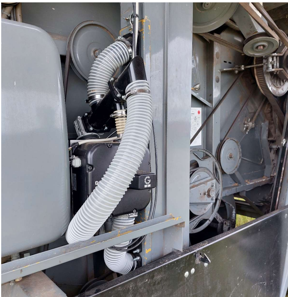
KUVA 8. GrainSensen virtausanalyysointilaite asennettuna
