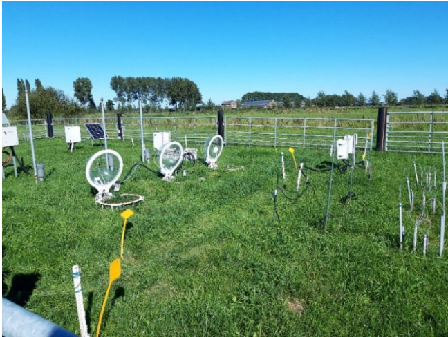
Tilalla mitataan kasviuonekaasupäästöjä testialueella. Suurin osa pohjavesiantureista on käsikäyttöisiä.
