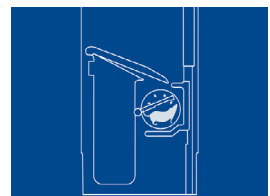
2 – Hissi nostaa jyräjän ylös ja ansa antaa kuolettavan sähköiskun
