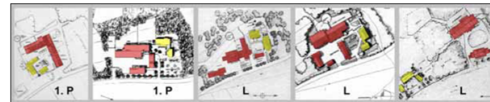
Kuva 9. Vuoden 1986 maatalon talouskeskuksen suunnittelukilpailun palkittujen ehdotusten asemapiirroksia (keltainen = asunto, punainen = tuotantorakennus). Rakennusten sijoittelussa on vielä tavoiteltu perinteistä umpipihaa joko yhden tai kahden pihan periaatteella. Yksi lunastetuista ehdotuksista on sijoittanut tuotantorakennukset selkeästi erilleen varsinaisesta asuinpihasta (kuva Arkkitehti-lehden kilpailuliitteestä 7/1986).
