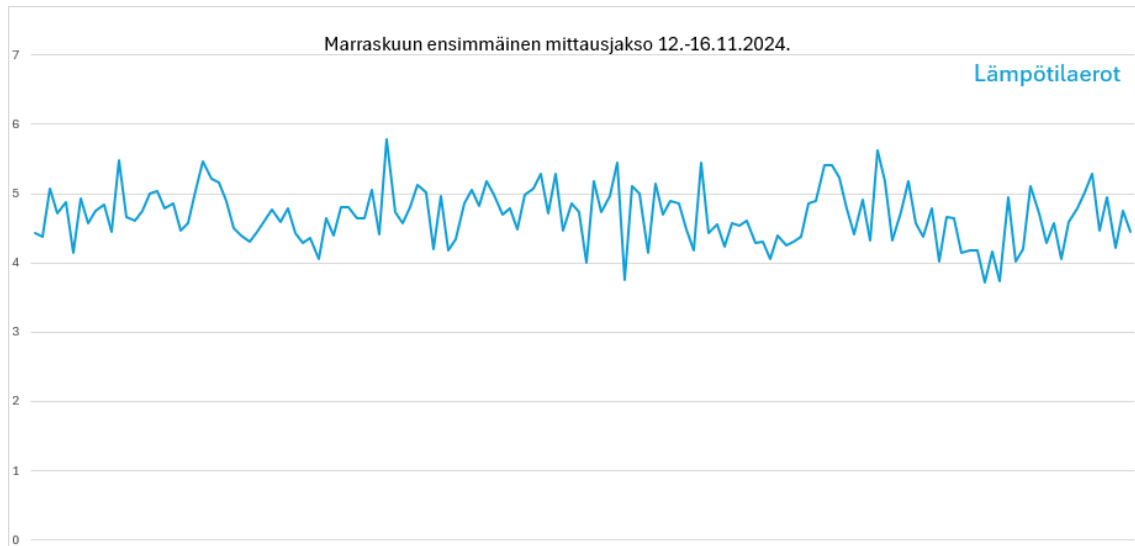
Kuva 13. Lämpöpumpun keruupiirin meno- ja paluulämpötilojen erotus 12.-16.11.2024.
