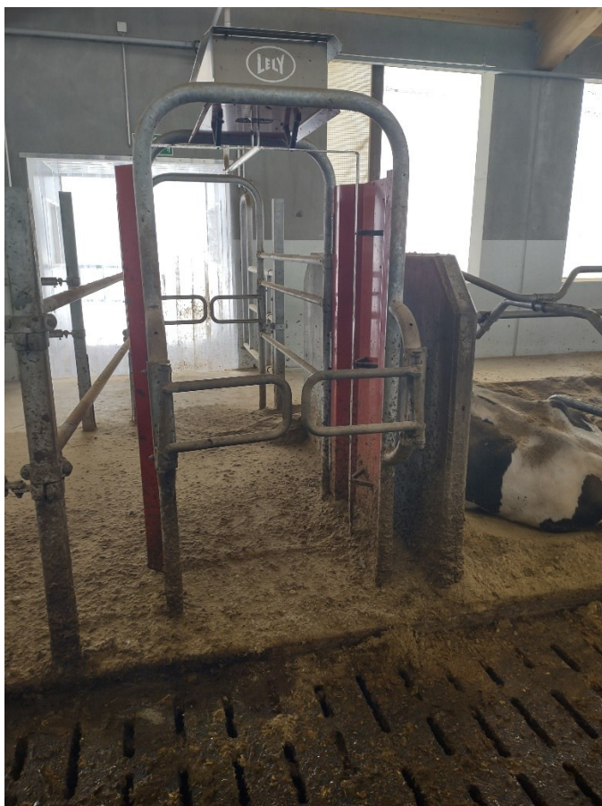
Kuva 7. Lely Grazeway paluuportti. Keski-Pohjanmaan ammattiopisto, opetusnavetta Kannus (Vattu 2023c).
