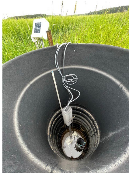
Kuva 3. Talvella 2021/2022 kehitettiin olemassa olevaan sääätosalaojakaivoon aurinkopaneelilla toimiva etäohjattava yksikkö. Laitteisto on liitettävissä olemassa olevaan kaivoon.
