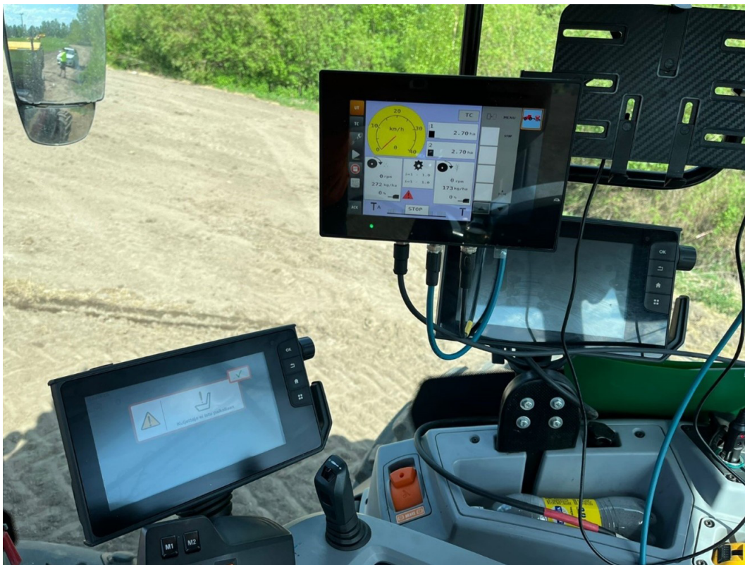
Kuva 3. CrossControl CC Pilot V700 -tehtävänohjain asennettuna Valtran T194D -traktoriin.
