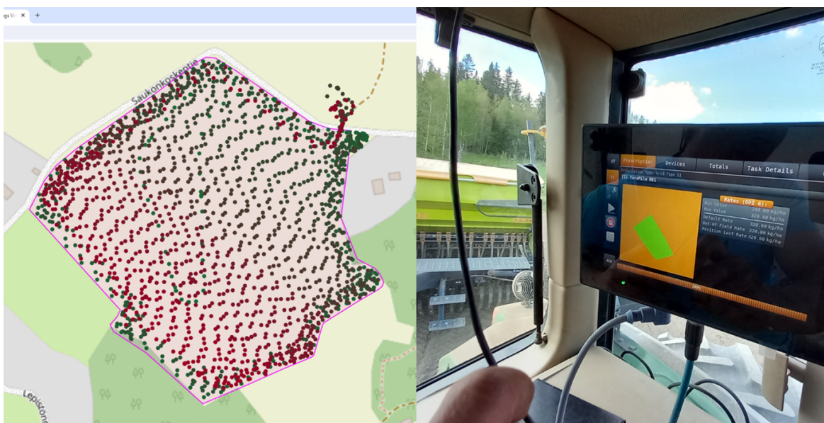
Kuva 14. Kylvölannoituksen toteusdatan lähetys Centrian datavarastoon ja datan visualisointi
