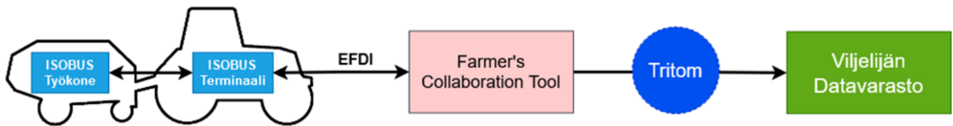
Kuva 3. Tiedonsiirto ISOBUS-työkoneelta viljelijän datavarastoon
