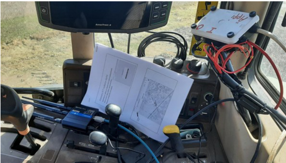
Kuva 10. ISOBUS-johtosarja ja -järjestelmä testattiin ennen kuin johtosarja instrumentoitiin traktorin hallintapaneelien sisälle.
