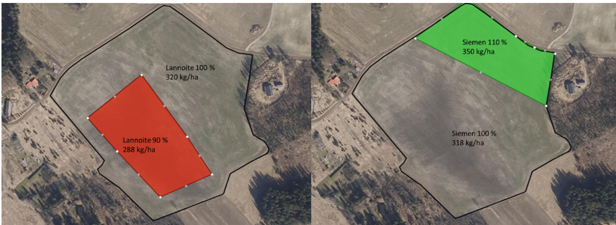
Kuva 12. Verkatakkilan tilalla Saukonkosken lohkolle luotiin lannoitteen ja siemenen säätökartat
